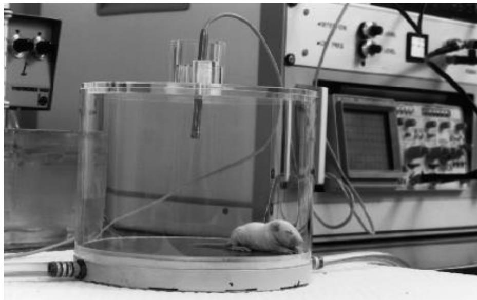
Cilindrična arena izolirana od zvukova kojoj je **u sredini poklopca umetnut UZ mikrofon**. Mladunče leži na **metalnoj bazi** koja se može grijati topлом vodom.
